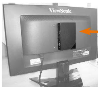
Le client zéro peut être fixé derrière l'écran (norme de fixation VESA)
